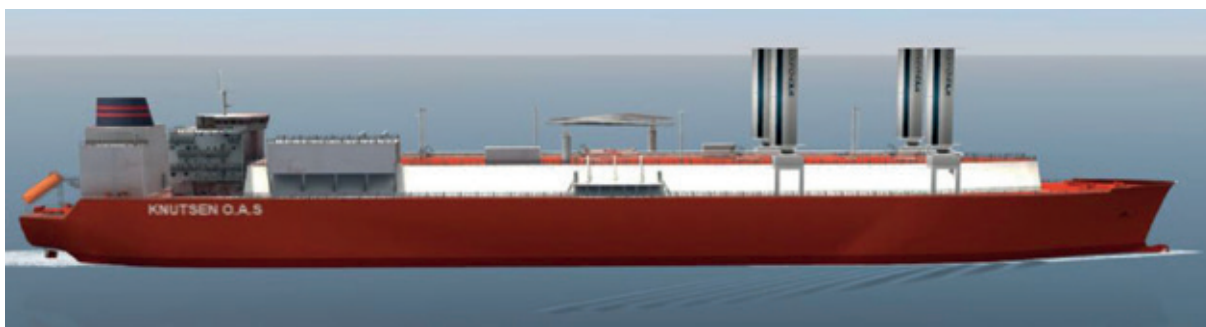
Figura 3.3. Modelo visual del buque Traiano Knutsen con las velas eSAIL de Bound4Blue en el simulador de maniobras en tiempo real de Siport21. Fuente: Elaboración propia
