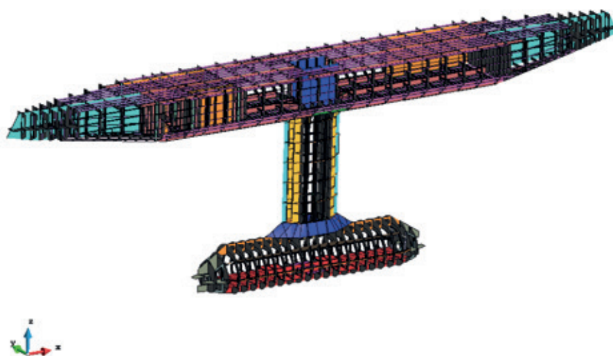
Figura 6. Vista general de la geometría del modelo MEF de la plataforma ATIR 2.0.
