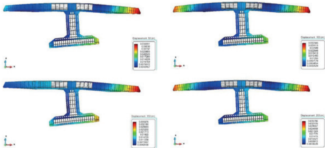
Figura 17. Diferentes instantáneas (50, 100, 150 y 200 s) de los resultados de la deformación de la estructura (amplificada 50 veces) en el caso 2 (0deg_7s) de la DLC 1.1.
