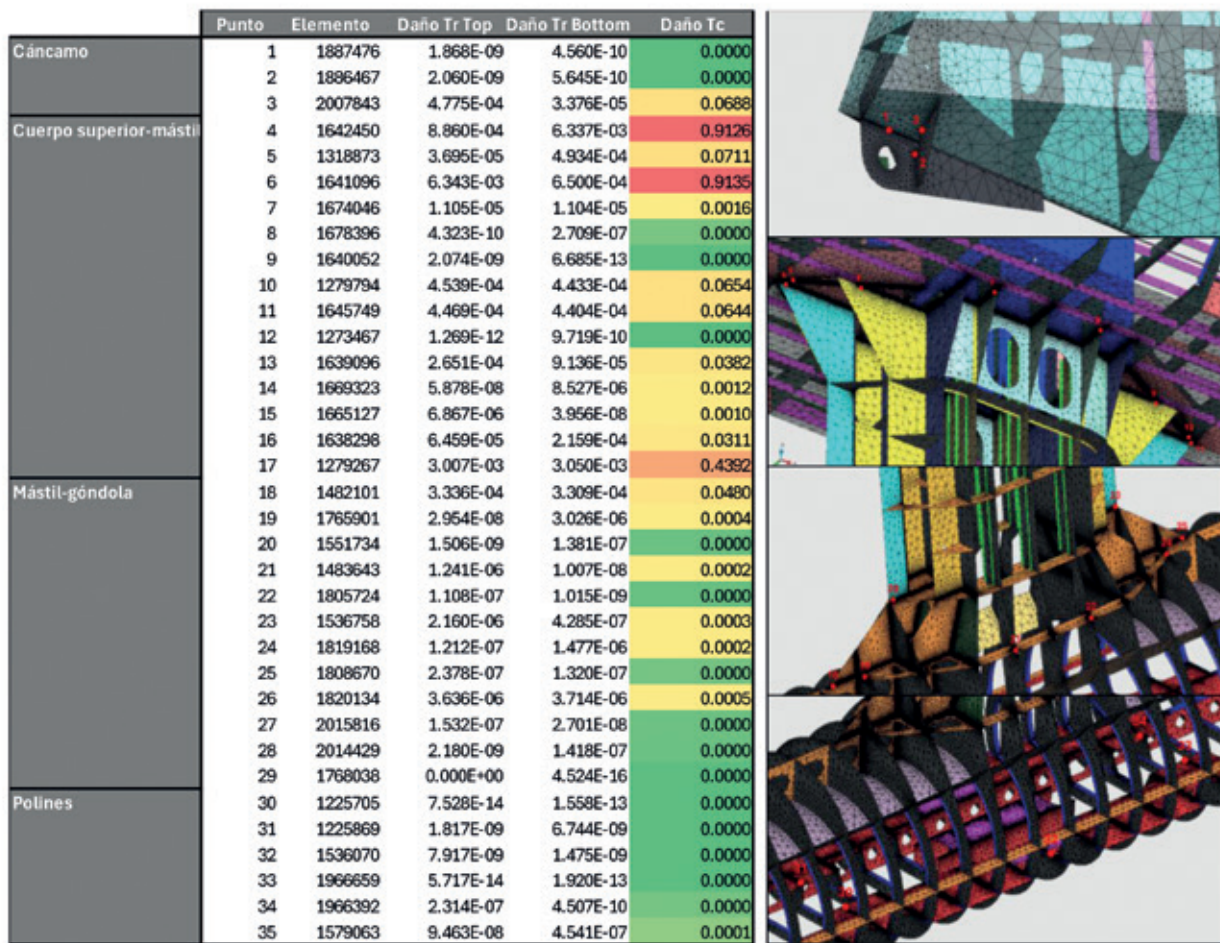
Figura 19. Estimación del daño por fatiga en un escenario seleccionado.
