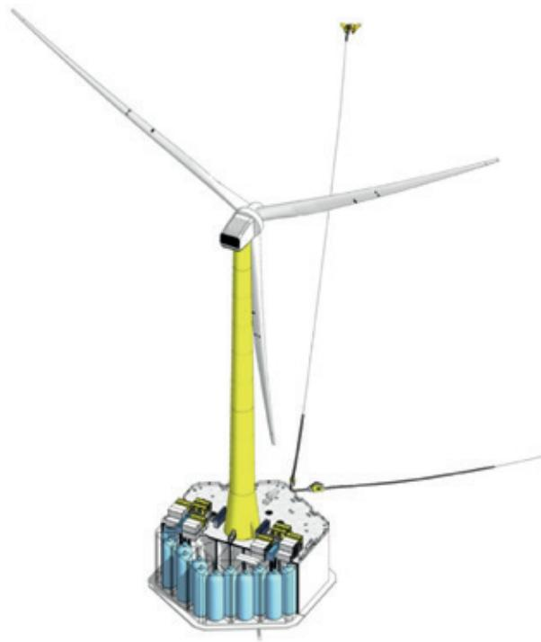
una herramienta ideal para la producción de hidrógeno verde directamente en alta mar, al integrar todos los componentes necesarios: desalinizadoras, electrolizadores, compresores y tanques de almacenamiento en sus cavidades interiores.
