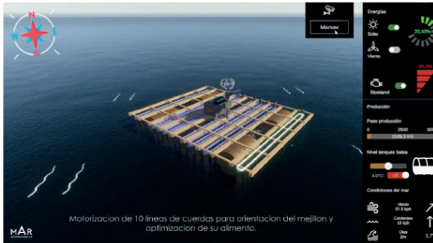
Motorización para una automatización completa del movimiento de cuerdas con sensórica para control de pesos, exposición alimento, etc..
