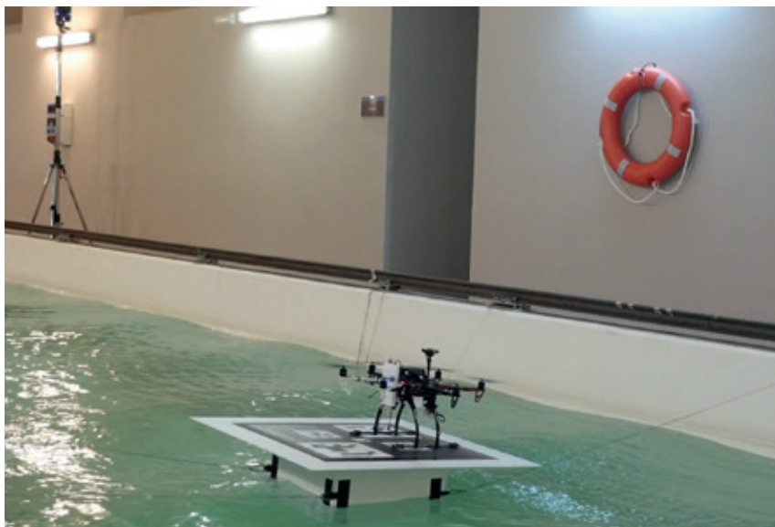
Figura 3. Atterrizaje del dron en la plataforma flotante en condiciones de viento y olas. CATEC / Universidade da Coruña. Canal de Ensayos Hidrodinámicos. CITENI, UDC (Campus Industrial de Ferrol)
