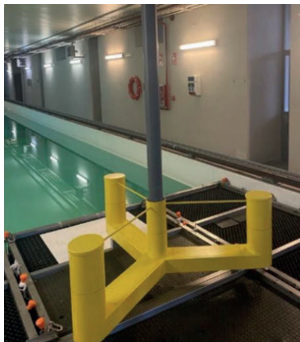
Figura 4. Modelo de plataforma semisumergible VoltturnUS seleccionada en este proyecto. Universidade da Coruña. Canal de Ensayos Hidrodinámicos. CITENI, UDC (Campus Industrial de Ferrol)
