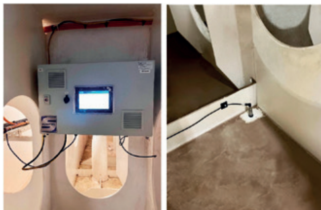
Imagen de la instalación a bordo de uno de los buques. Puede apreciarse el sensor de mediciones de vibraciones conectado al casco en la imagen de la derecha.
