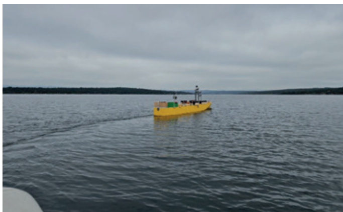
Ilustración 3. Ensayo de zig-zag desde la embarcación auxiliar
